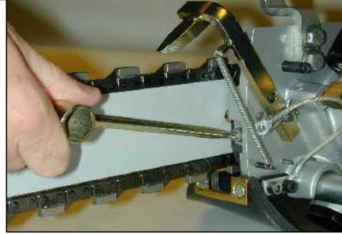
ETAPA 7: Estique a corrente. A corrente deve estar tensa, mas deve ser possível rodá-la à mão em torno do guia. Ver Notas 1 e 2.
