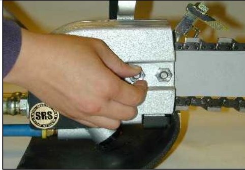
ETAPA 6: Instale o guarda-corrente e aperte as porcas à mão.
