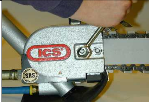
ETAPA 8: Levante a ponta do guia e aperte bem as porcas do guarda-corrente. Ver Nota 3.
